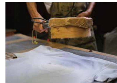
静電気で繊維を垂直に植え付ける工程。1点ずつ手作業のため時間を要するが、繊細で多彩な表現が可能
