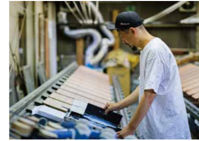
フロッキー加工では、特殊加工したのりを下地に塗布した後、静電気を使って繊維を垂直に植え付ける。写真はのりをシルクスクリーンで刷り付けるところ
