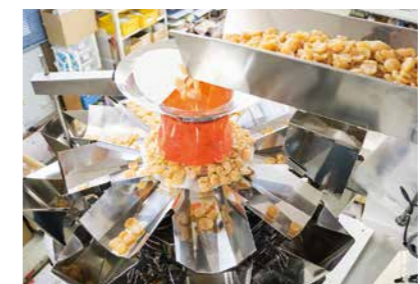
融資活用で導入した最新の計量器。大小様々な菓を瞬時に分別し、設定した内容量に正確に袋詰めできる。手作業だった誤差修正の必要がなくなったほか、同じ原材料投入量あたりの生産数もアップした
